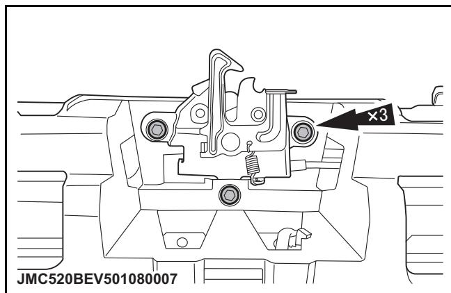
5. 脱开拉索固定端，取下发动机舱盖罩锁。
