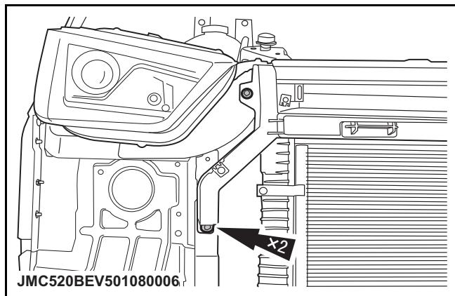
4. 用 8mm 套筒拆卸发动机舱盖罩锁 3 个固定螺栓 (M6×18)。
